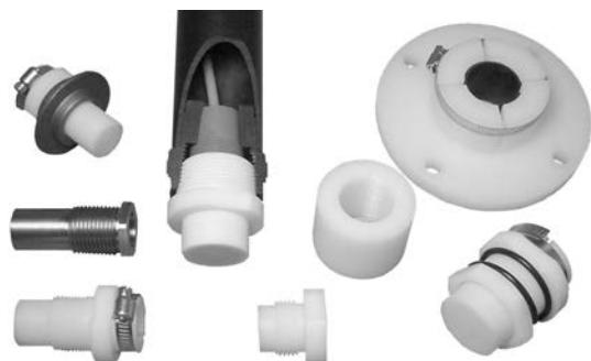
**设计说明** 塞式探测支架通常适用于电容传感器且支架末端为闭合型，在用于超声波及光电传感器的情况下，其支架末端必须为敞开型来用于正确的传感器操作中。所有索福诺思的塞式探测支架普遍设定为闭合型，也可设为敞开型，只需将简单的代码前缀由SW，更改为SWO。
