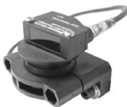
SUB-MPB 改装的SUB-MPB和 迷你光电传感器
